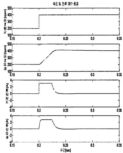
그림 6. 가속시 스텝응답(200→400RPM)
