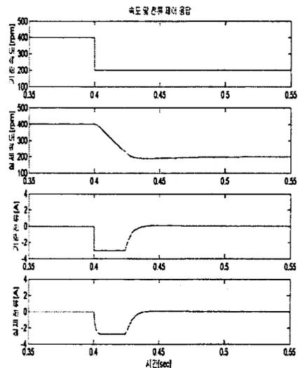
그림 7. 감속시 스텝응답(400→200RPM)
