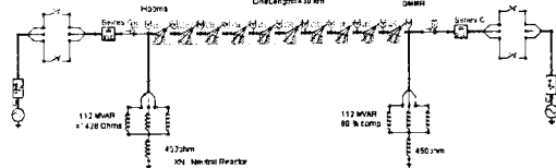
그림 3. 2차 아크전압 계산을 위한 EMTF 해석모델
