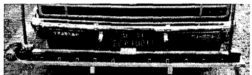
[그림 8] 레이저 변위 센서의 장착
