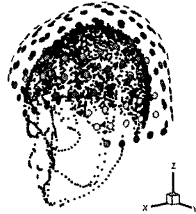
그림 4. 시뮬레이션에 사용된 148 채널 SQUID magnetometer로 이루어진 MEG system
