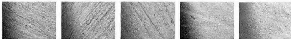
수세미 4회 Scratch 수세미 8회 Scratch 수세미 12회 Scratch 습식제염장비 20초 운전 습식제염장비 40초 운전
