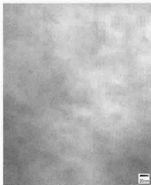
그림 2 조사 이전 TEM 사진 (850°C-5hr-WQ, Fe-1.0wt%Cu)
