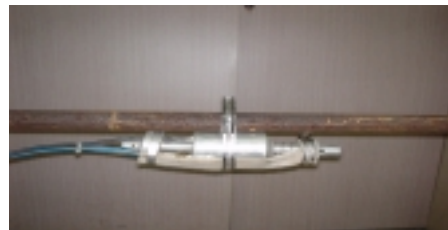
사진 4. 발진기와 감지기를 사용한 강봉에서의 신호측정
