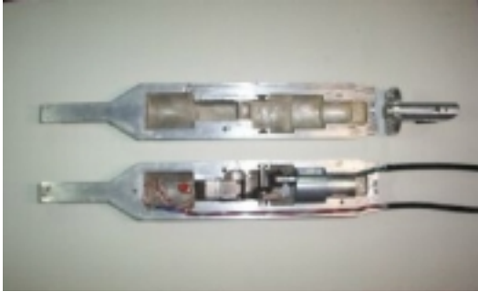
사진 2. 모터를 이용한 3차 스프링식 발진기 분해도(좌), 세부도(우)
