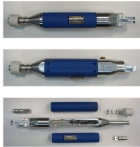
사진 1. 2차 스프링식 발진기 정면도(상), 측면도(중), 분해도(하)
