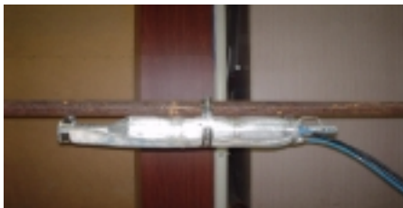
사진 4. 발진기와 감지기를 사용한 강봉에서의 신호측정
