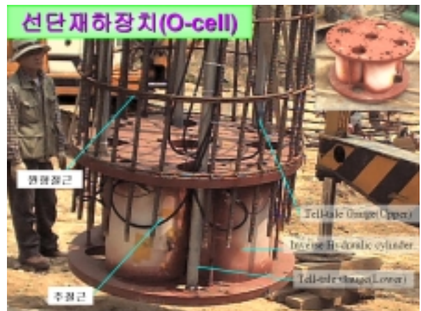
그림 4. 1/2 모형 현장타설말뚝 및 Osterberg Cell
