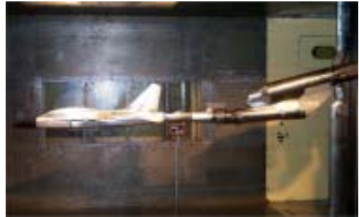
Fig. 1 T-50 항공기모델 천음속 풍동시험
