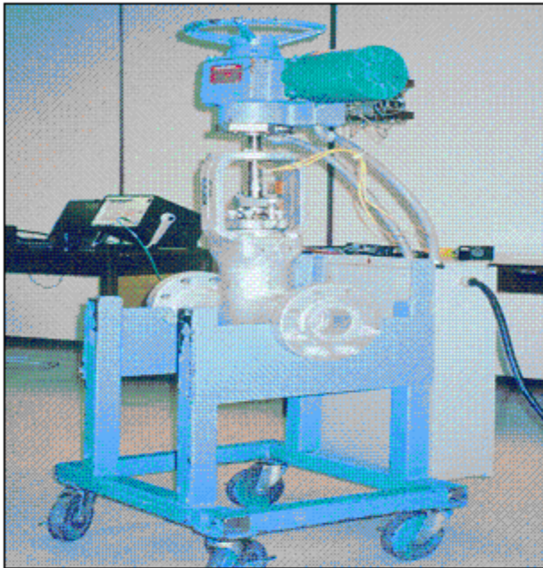
그림 24 TTC 장치를 완료하여 yoke와 actuator를 연결하기 전 모습
