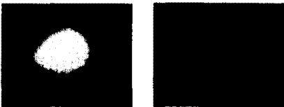
(a) LPG 연소 (b) 석탄가스화 화염 Fig. 5. LPG 연소 및 석탄가스화 화염비교
