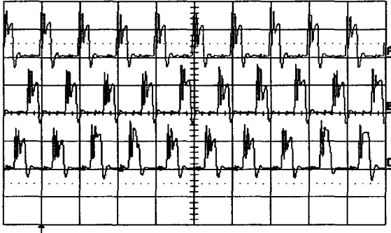
그림 14 3000rpm에서의 3상 전류파형 (10A/div, 5ms) Fig.14 Current waveform of 3ph. phase(3000rpm) (10A/div, 5ms)
