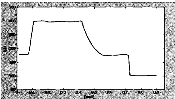
(b) 고정 PI 적용시 속도 파형 (b) Simulation results of fixed PI gain
