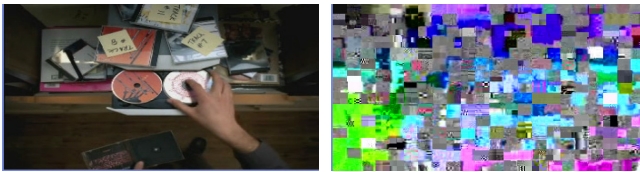
(그림 9) I-VOP 내의 매크로 블록과 P-VOP 내의 모션벡터를 모두 암호화한 결과
