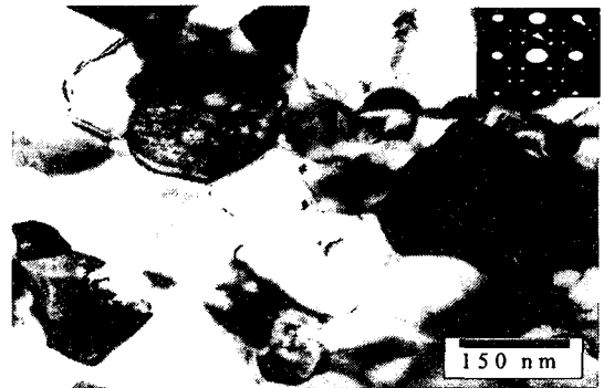
그림 2. 900℃에서 2시간 소결한 BMN+2.0 mol%B 2 O 3 +10.0 mol%CuO 세라믹스의 TEM 명시야상.
