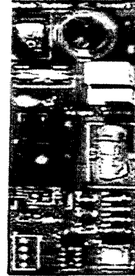
그림 11. 푸쉬버튼을 이용한 AC 아날로그 디머 제어모듈
