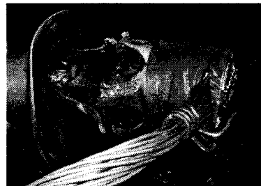
그림 8 배전 케이블 중단 접속부에서 발생한 절연파괴 사진
