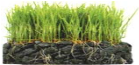
<그림 3.2> Mattress/Filter내의 식생성장
