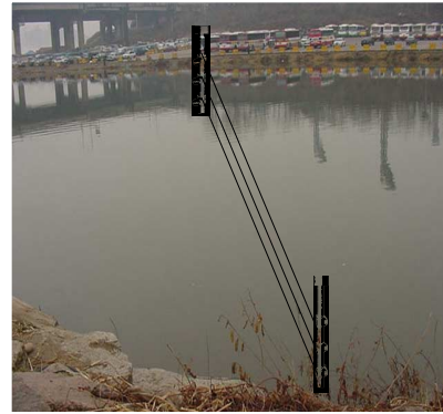
그림 6 초음파 유속계 설치 개념도
