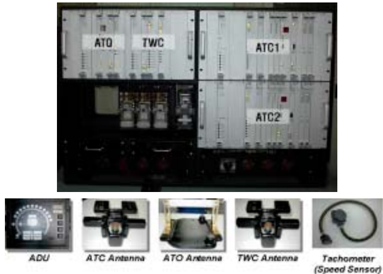
<그림 1. 광주도시철도1호선 차상 ATC/ATO>
