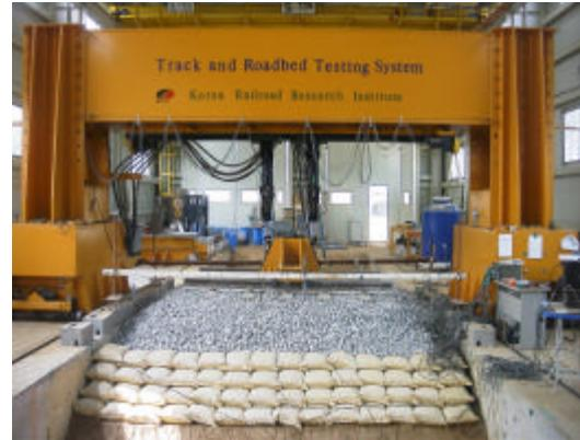
그림 6 토목섬유 콘테이너 시험 전경
