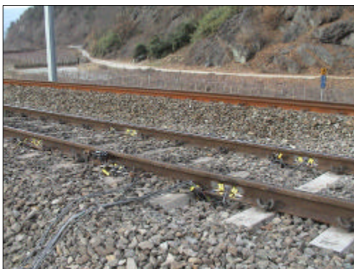
그림 2. 곡선부 현장에 설치된 센서
