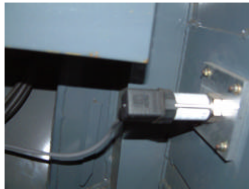
그림 2. 계측시스템의 구성도 및 열차 외판에 부착된 압력계 모습
