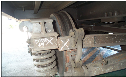
그림 1 50178호 엔드빔 균열
