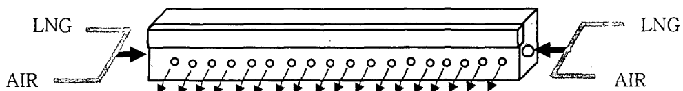
그림 7 electrode holder ass'y 가공도
