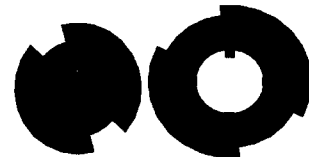
(a)송신 안테나 (b)수신부 안테나 (a)Tx antenna (b)Rx antenna
