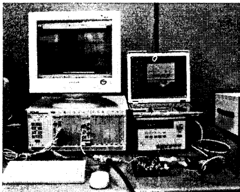
그림 6. 제작한 칩 신호 발생기로 대체한 시스템
