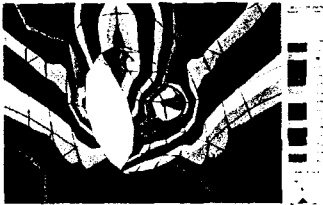
그림 7 수직하중 작용시 윤중 측정위치의 \sigma_{zz} 분포
