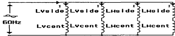
그림 6. 2軸 자기장 발생장치의 수평(LH), 수직(LV) 코일의 연결 방식. Fig. 6. Connection method of horizontal(LH), vertical(LV) coils of 2-axes magnetic field source.
