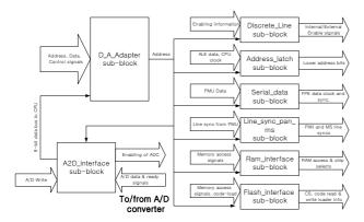
Fig. 3. FPGA's DECODE\_LATCH block Diagram
