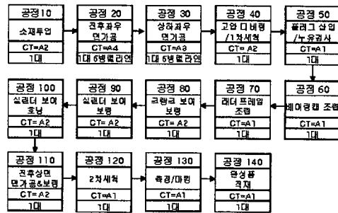
[그림 3] 엔진블럭 제조 공정
