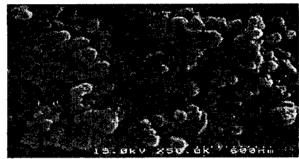
그림 3. Pt 1wt%를 첨가한 SnO 2 SEM 사진.
