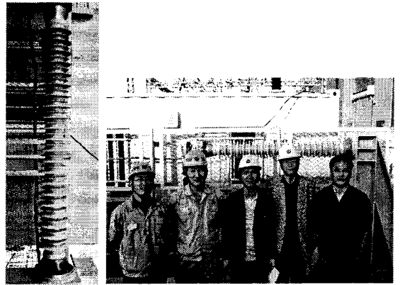
그림 8. 성형 복합애자와 비틀림파괴하중시험 지그 설치
