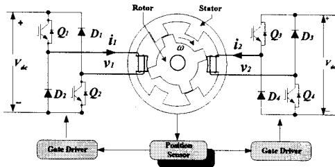
그림 3 제안된 병렬권선방식의 SRM 구동시스템
