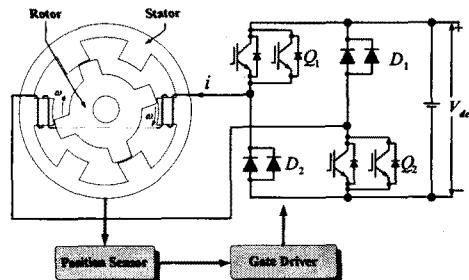
그림 1 기존의 병렬스위칭 방식의 SRM 구동시스템
