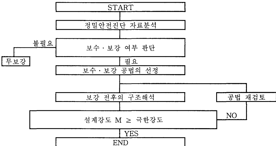
<그림. 1> 도로교의 보수·보강 전후의 구조검토 흐름도
