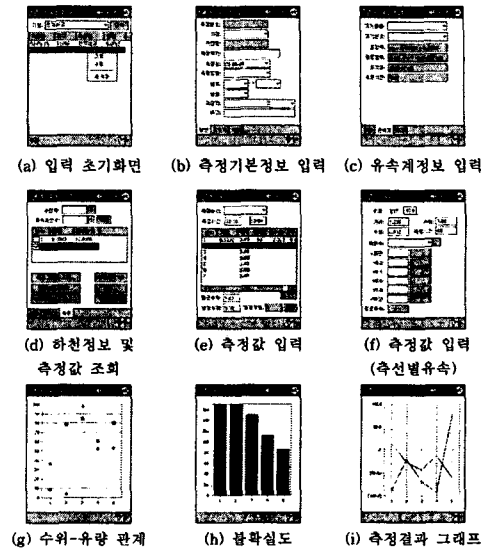
그림 3. 유량측정용 PDA 시스템의 전체 개요
