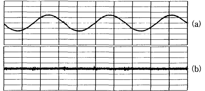
그림 13. (a)인버터 출력전압과 (b)부하전류 파형 (무부하) Fig 13. (a)Output voltage and (b)load current (200V/div, 5A/div, 5ms/div)
