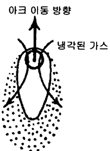
그림 5 자기 구동력에 의한 아크 냉각 현상
