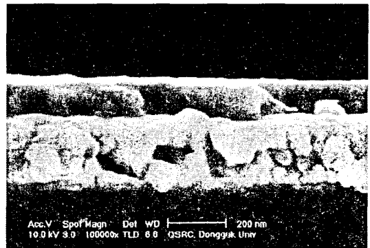
그림 2. 3 mol%의 Eu이 첨가된 PZT 박막의 SEM 단면 사진
