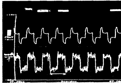
그림 3. 입력파장 1340.23 nm 에서의 전광 Flip-Flop 측정결과. Fig. 3. All-optica Flip-Flop at input wavelength of 1340.23 nm.
