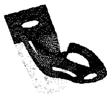
그림 9. Sway 모드(9792 Hz)
