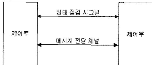
제어부는 단일 모드 혹은 이중화 모드로 동작할 수 있다. 이중화 모드로 동작할 때는 먼저 실장 된 제어부가 액티브 제어부가 되며 좌, 우측의 제어부가 동시에 실장이 되었고 두 제어부가 모두 정상적으로 동작하고 있다면 실시간 적으로 먼저 액티브 권을 습득한 제어부가 액티브가 되도록 하였다. 이는 운용의 편의를 위하여 좌측 제어부를 우선적으로 액티브 권을 습득하게 할 수도 있다.
