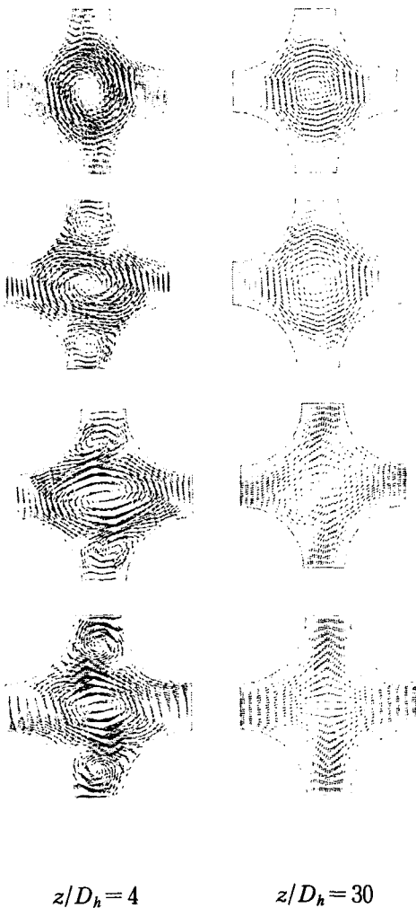
Fig. 5 Velocity vectors in the subchannel: NJ15, NJ25, NJ35, NJ45(from top) 두 단면에서 네 가지 유형의 혼합날개에 대한
