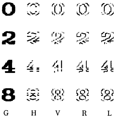
[그림 1] Kirsch mask를 이용한 4 방향 추출
