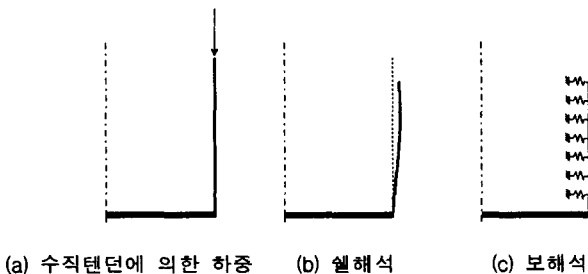
그림 5 수직텐던 및 프와송비에 의한 휨모멘트의 유발
