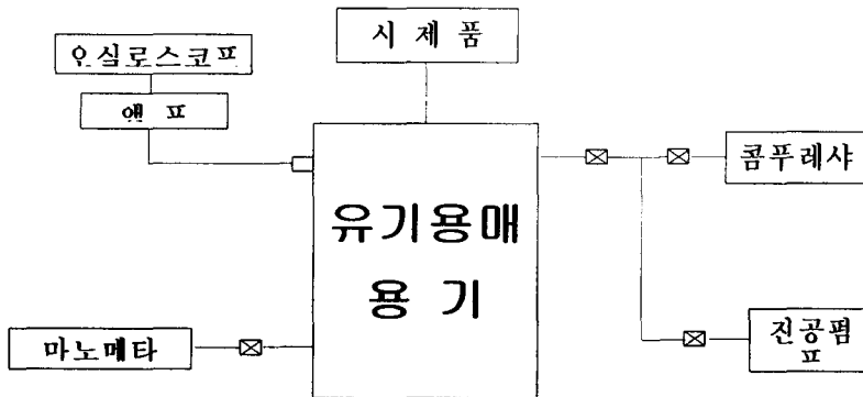
그림 4. 밸브의 개 폐 작동압력 측정 실험장치 개략도
