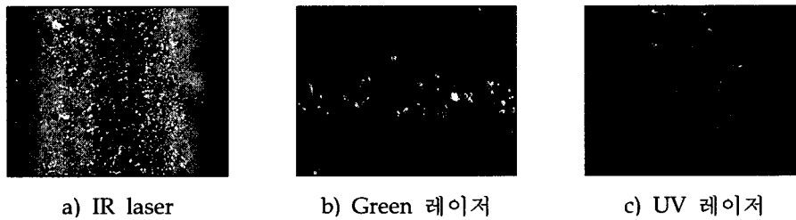
Fig 3. Laser 파장에 따른 증착 특성
