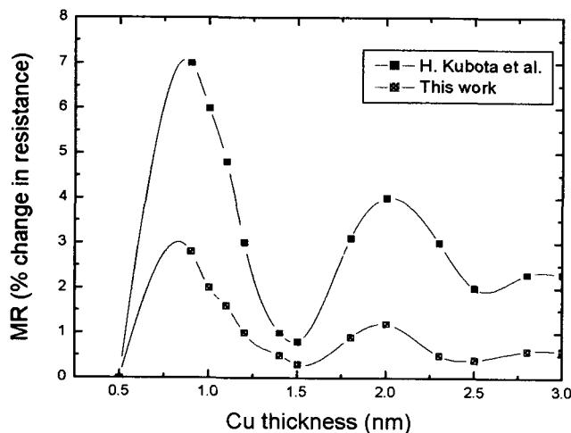
전기화학적으로 제조된 multilayer를 EQCM, AES, TEM, STM, XRD 등을 통해 characterization 함으로써 electrodeposition이 nano-multilayer 제조의 효과적인 방법임을 확인하였고 또한 multilayer의 magnetic properties는 non-magnetic layer의 두께 및 layer structure에 의해 변화한다는 사실을 규명하였다.
