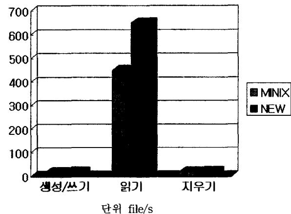
예상대로 새 파일 시스템이 여러 파일 오퍼레이션에서 MINIX 파일 시스템보다는 빠른 수행시간을 보인다. 파일
