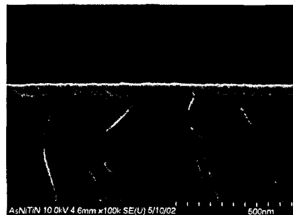
그림 4. 500°C에서 RTP한 As 도핑된 Sample의 실리사이드 FESEM 사진. Fig. 4. Cross-sectional FESEM image of As-doped active region with a RTP temperature of 500°C.
